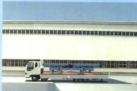
①トラック搬送時（11tトラック）
